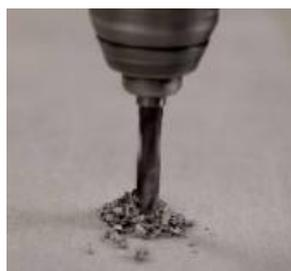
Quando si fora un pannello, posizionarlo su un solido banco da lavoro all'interno. Non forare mai il pannello sotto la pioggia. Forare un solo pannello alla volta. Disattivare la funzione di percussione del trapano.
