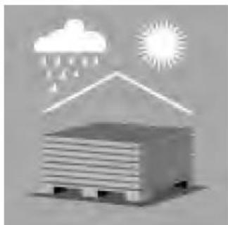
EQUITONE [materia] deve essere stoccato in piano su un pallet, all'interno e al coperto in condizioni di asciutto. Impilare i pallet in modo che i pannelli siano ventilati. Se si lascia penetrare condensa o umidità tra i pannelli stoccati, si verificherà una colorazione permanente della superficie sotto forma di efflorescenza. La protezione esterna in plastica può causare condensa se non è ventilata.
