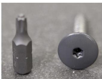
Le viti EQUITONE UNI-screw per legno sono realizzate in acciaio inox A2 (304) ISR T20 Torx TTAP® con la testa da 15 mm di diametro. Le viti sono disponibili con la testa dello stesso colore del pannello. È disponibile anche una vite UNI con la testa non verniciata.
