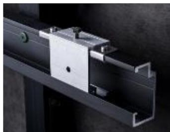
Per evitare lo scorrimento laterale del pannello si possono usare delle viti di bloccaggio o le apposite clip fissate sul profilo orizzontale su un gancio nell'angolo superiore del pannello. Assicurarsi di posizionare il bloccaggio sempre sulla stessa parte dei pannelli, tutti a destra o tutti a sinistra dei ganci di livellamento.
