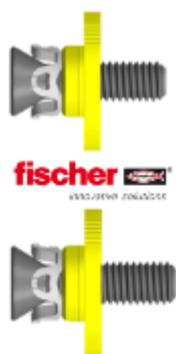
In base alla sottostruttura utilizzata si determina la lunghezza del tassello. Per EQUITONE [natura] si usa il tassello con la rondella gialla che assicura il corretto inserimento per i pannelli da 12 mm.
