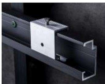
I ganci utilizzati sulla parte alta del pannello hanno un foro filettato che permette la regolazione dell'allineamento verticale del pannello. Questi ganci sono quelli che supportano il peso del pannello.
