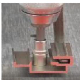
Evitare che il gancio possa ruotare durante il fissaggio quando si fissa tenendolo con una mano. Per questa procedura devono essere indossati i guanti di protezione.
